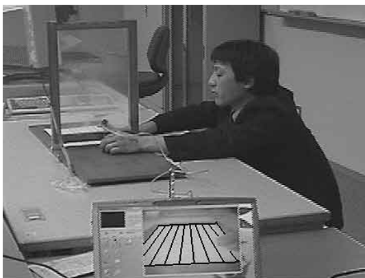
図5 透視図を描くための器具。左手に持っているのがカメラで、手前にあるの画面が、そのカメラで映し出されたスクリーン
