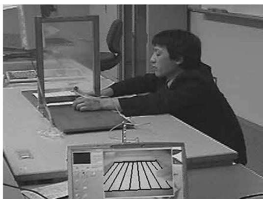
図5 透視図を描くための器具。左手に持っているものがカメラで、手前にあるの画面が、そのカメラで映し出されたスクリーン
