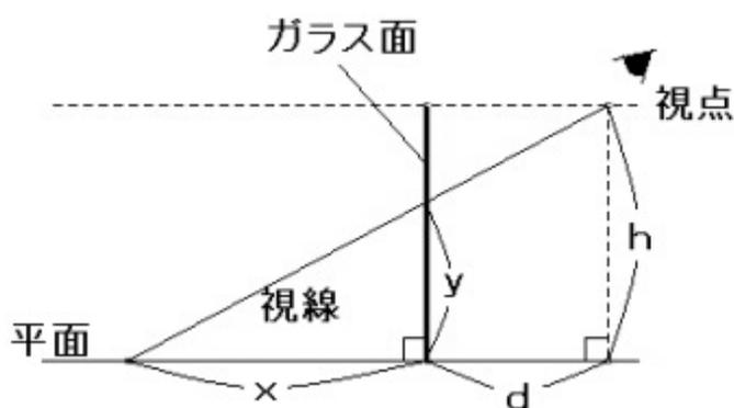
図6：透視図法のモデル化(側面図)
