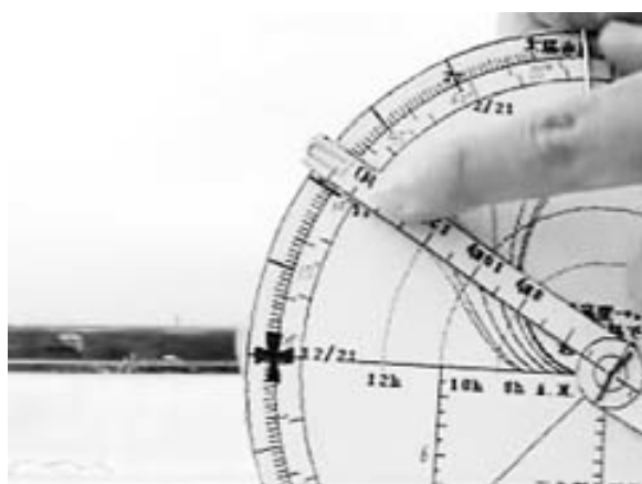
写真5 指方規が指している円盤の淵上にある目盛りが、対象物の『高度(=仰角)』
