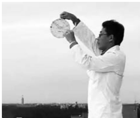
写真4 アストロラーベ裏面の基本的な使い方。太陽や月、塔のてっぺん等の対象物と自分を結ぶ線分と平行に指方規(定木)を合わせる。
