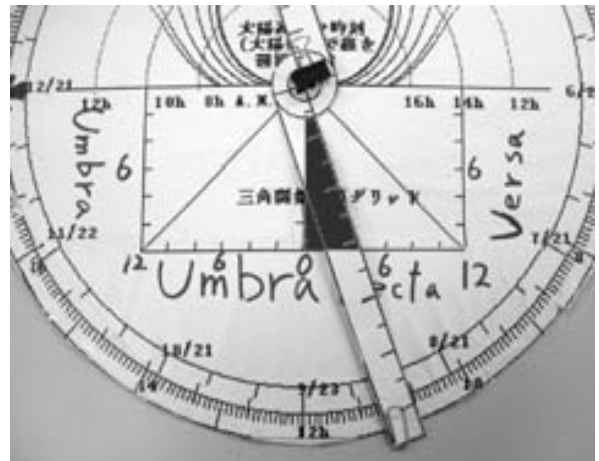
写真7 umbra rectaが4の目盛りを指している状態。黒く反転した三角形が、塔と自分のなす三角形の縮図
