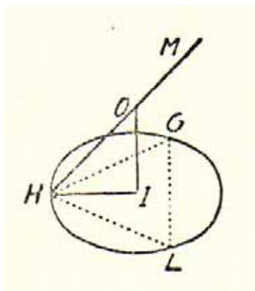
左図の場合、OIが内接球の半径にあたるが、三角形OHIに注目して、三平方の定理を使えば直ちに求められる。OHの長さは正多面体の外接球の半径と一致し、HIの長さは基底面の外接円の半径と一致している。外接球の半径についてはもうすでに求めているのであとは、基底面の外接円の半径を求めれば良い。
