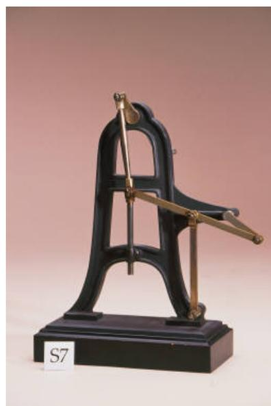
図2 Approximate Four-Bar, Ellipse Linkage of the Third Kind(手頃なものがなかったため代用)
