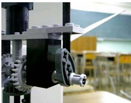
写真が変更点としてカムを用いた機構である。「KMODDL」のサイトで調べたところ、構造的に特に一致するものは無かったが、「Eccentric Drive」と呼ばれるものが比較的似ていた。
