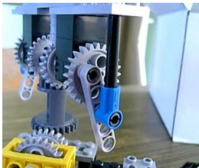
一号機での失敗を受け、「KMODDL」のサイトを参考にして、円盤・棒パーツに加え、軸パーツを取り付けたクランク機構である。「Eccentric slider crank Mechanism」と呼ばれるものと一致している。
