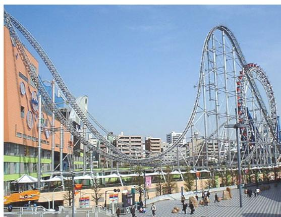
ローラーコースターは遊園地で目立つ大きな乗り物の一つである。しかし、見た目とは違い、時には1 km を越える長いコースを単純な機構のみによって列車を走らせている。ローラーコースターは乗客のいる列車自体には基本的に動力などは存在しない。一般的に、リフトなどを使って最高点まで列車を引き上げ、そこから下りの傾斜を走らせることで位置エネルギーを運動エネルギーに変えて速度を上げる。その後は最初のエネルギーを、傾斜を上ったり下がったりすることでエネルギーを次々に変換して緩急をつけて動いている。そして最後にブレーキなどで余剰エネルギーを吸収して終了する。
