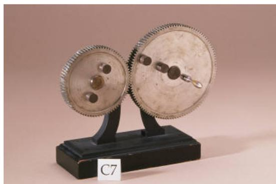
図のようにギアを組み合わせることで、片方のギアを回すともう片方のギアが逆回転になる。また、前の節で述べたように、組み合わせるギアの歯数の比を変えることで、回転の速さを変えることができる。具体的には、片方を回した角度に対し、もう片方が回転した角度はギアの歯数の反比例している。つまり、歯数の多い方のギアを回したときもう片方のギアはそれよりも大きな角度を回転し、逆に歯数の少ない方のギアを回したときは、もう片方のギアはそれよりも小さな角度を回転する。回転した角度と回転の速さ是对応しているため、歯数の多い方を回せば速く、少ない方を回せば遅くなって次のギアに伝わる。
