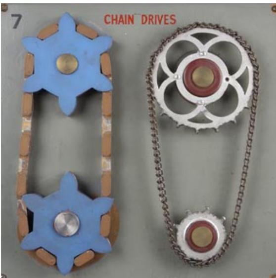
基本的に仕組みは 3.4. の Belt Drive Mechanism と同じであり、2つのギア(特にチェーンに組み合わせて使うものをスプロケットと言う)にチェーンを張ることで、それに物を引っ掛けて運ぶことが可能になる。ベル
