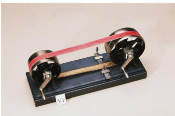
図のようにベルトを2つのホイールに張り、ホイールを回転させることでベルトに回転を伝えている。ベルト自体はタイヤ状であるが、ホイールの距離を調節してベルトをうまく張ることで、ベルトの面が平面になり、回転運動を直線的な運動に変え、その上に物を載せて運ぶことができる。なお、実際は上の図のベルトに該当するパーツがLEGOに無かったので、キャタピラのパーツを応用してベルトとした。
