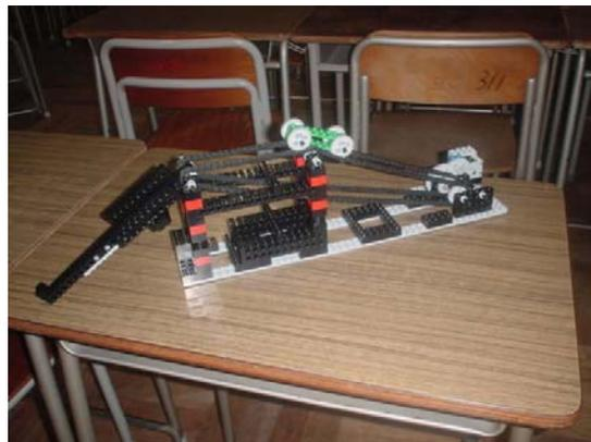
チェーンは細かい部品をつなぎ合わせて作るので、長さの調節が自由にできる。動力はモーター→ギア→チェーンと伝わっている。
