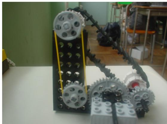
3.2節のベルトの機構を利用して、同じ回転を両方のホイールに与えてベルトに回転を伝える構造を採った。これによって、ベルトに負荷がかからずにスムーズに回転するようになった。また、共同で製作にあたった2人が作った装置も合わせて紹介する。
