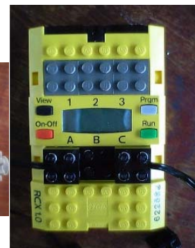
電源 (単3電池6個で稼働)
